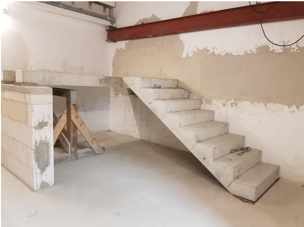
Abbildung 8: Referenztreppenlauf starr an das Referenztreppenpodest angebunden
