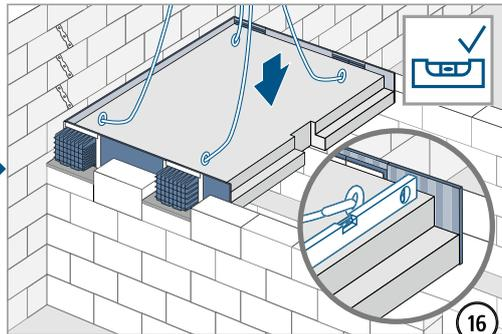
Die Höhenlage des Podests ist durch druckfeste **Ausgleichsplatten** (z. B. aus Stahl, Mindestgröße 250 × 160 mm) zu justieren.
