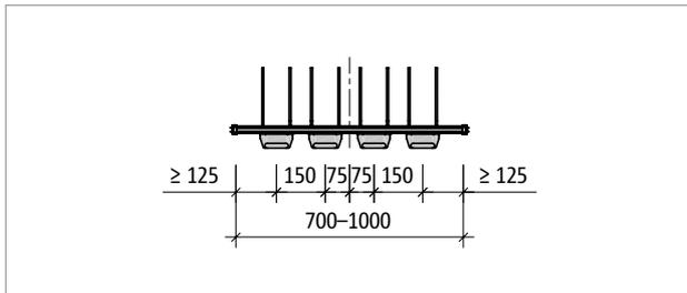
Abb. 121: Schöck Tronsole® Typ T-V4...-L700 bis L1000: Produktgrundriss
