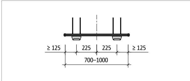
Abb. 119: Schöck Tronsole® Typ T-V2...-L700 bis L1000: Produktgrundriss
