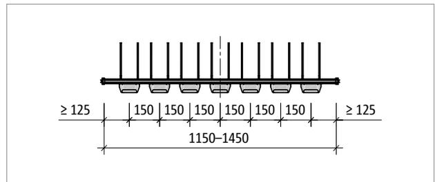
Abb. 128: Schöck Tronsole® Typ T-V7...-L1150 bis L1450: Produktgrundriss
