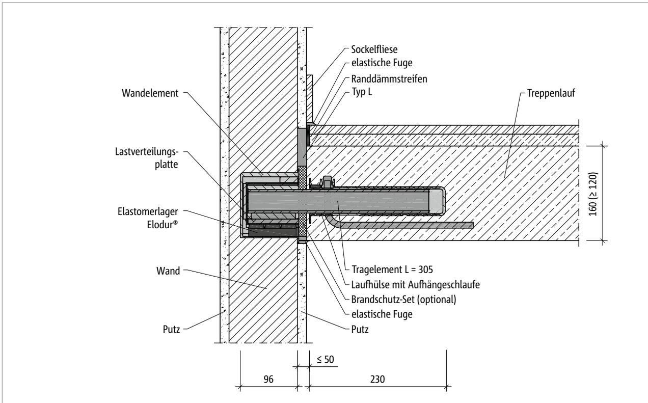
Abb. 83: Schöck Tronsole® Typ Q-FV oder Q-A2: Einbauschritt Wanddicke 11,5 cm
