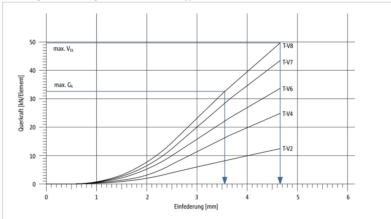
Abb. 139: Schöck Tronsole® Typ T: Verformung des Elastomerlagers Elodur®
