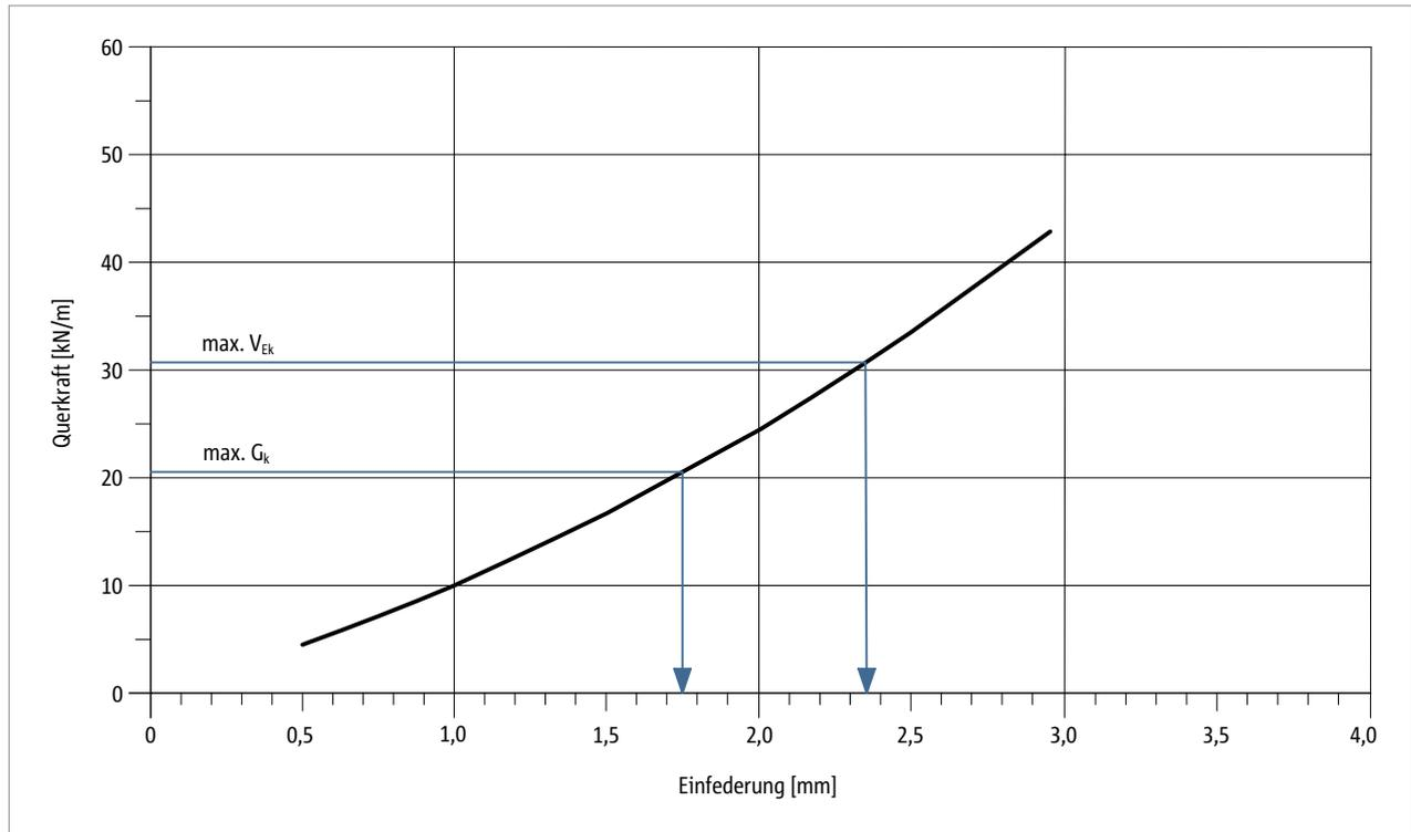
Abb. 185: Schöck Tronsole® Typ B-V1: Verformung des Elastomerlagers Elodur®
