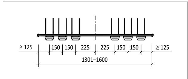
Abb. 126: Schöck Tronsole® Typ T-V6...-L1301 bis L1600: Produktgrundriss
