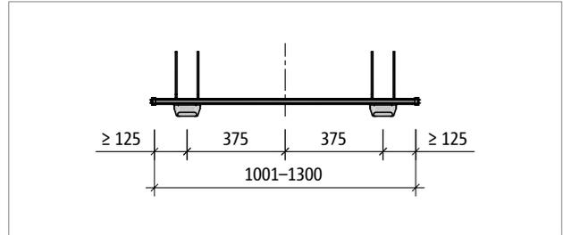
Abb. 120: Schöck Tronsole® Typ T-V2...-L1001 bis L1300: Produktgrundriss
