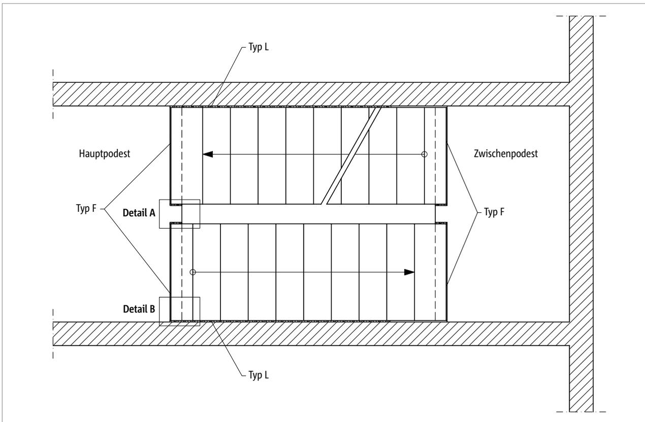
Abb. 148: Schöck Tronsole® Typ F: Elementanordnung im Grundriss
