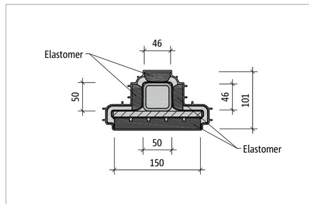
Abb. 33: Schöck Tronsole® Typ P-VH+VH: Produktquerschnitt B-B
