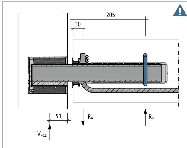
Abb. 46: Schöck Tronsole® Typ P: Bauseitiger Hutbügel eingefärbt
