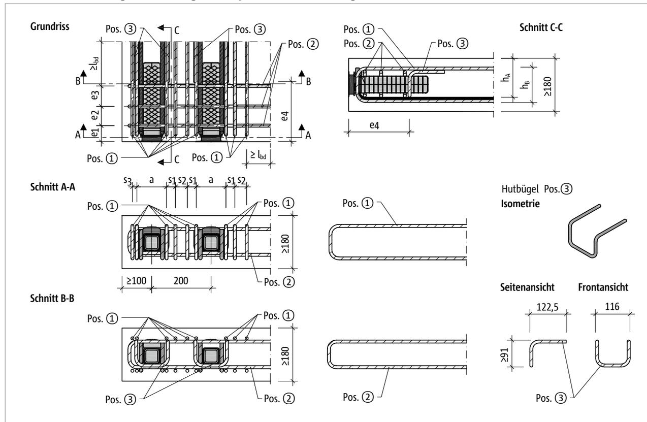
Abb. 38: Schöck Tronsole® Typ P: Bauseitige Bewehrung für die paarweise Anordnung
