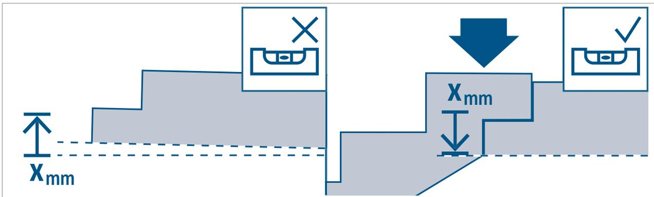
Abb. 42: Schöck Tronsole® Typ P: Überhöhung gemäß Werkplan
