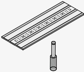
B-V1:  $\Delta L_{w,Lauf}^* \geq 28$  dB; B-V2:  $\Delta L_{w,Lauf}^* \geq 27$  dB; B-V3:  $\Delta L_{w,Lauf}^* \geq 23$  dB; optionaler Dorn zur konstruktiven Lagesicherung
