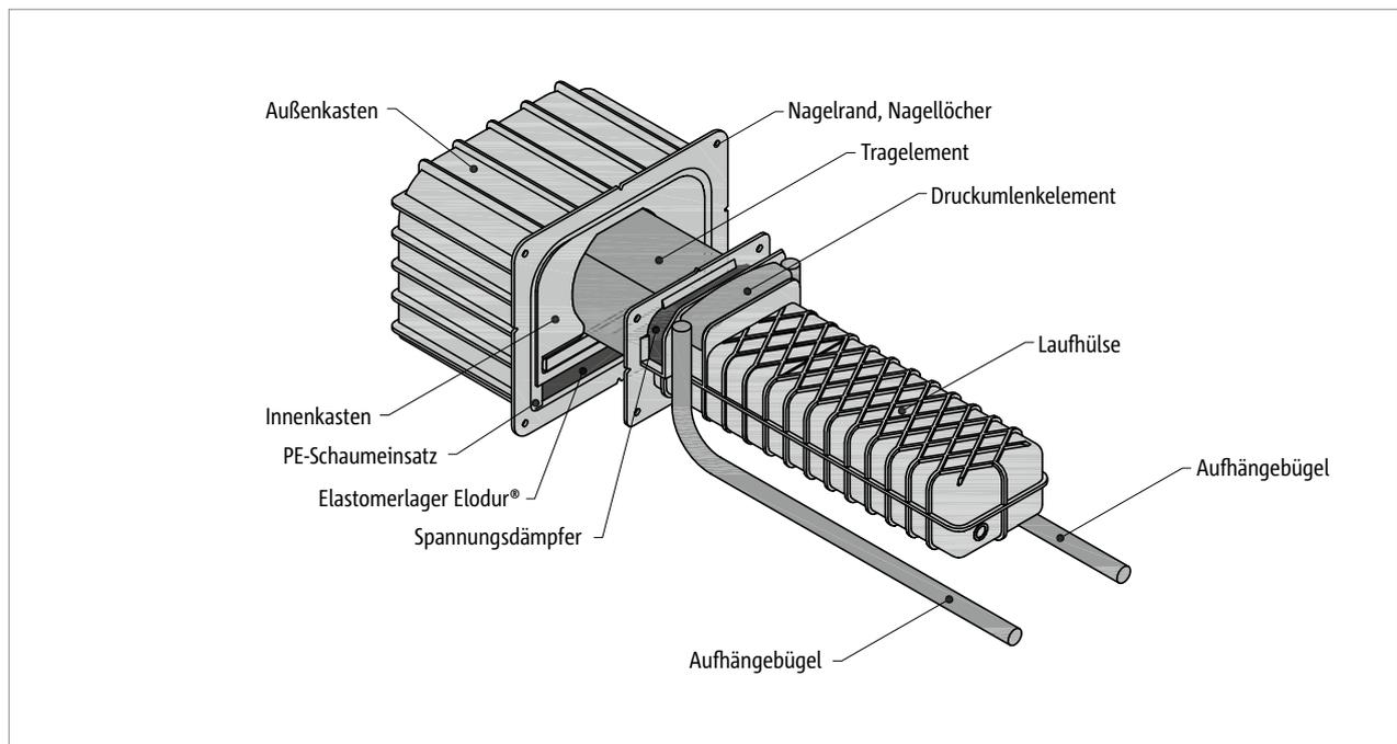
Abb. 74: Schöck Tronsole® Typ Q: Wandelement, Tragelement und Laufhülse mit detaillierter Benennung wichtiger Bestandteile
