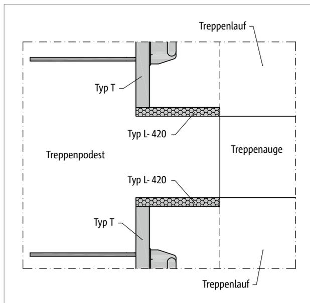
Abb. 112: Schöck Tronsole® Typ T: Elementanordnung Detail A
