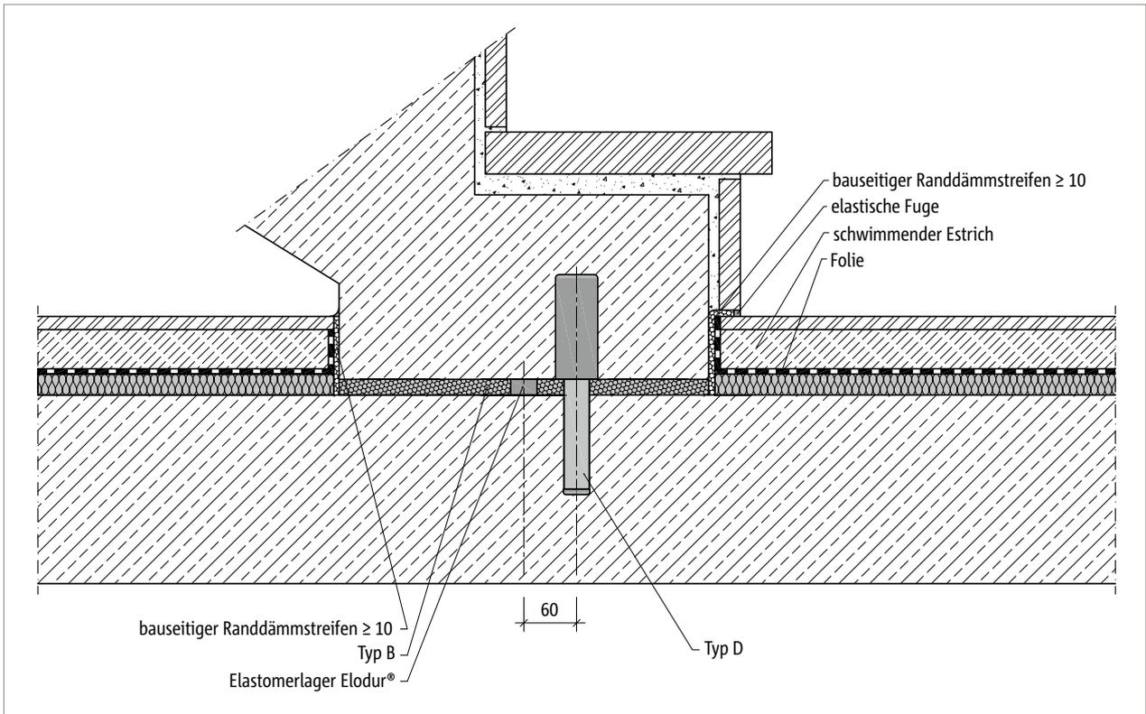
Abb. 171: Schöck Tronsole® Typ B + Typ D: Einbauschnitt
