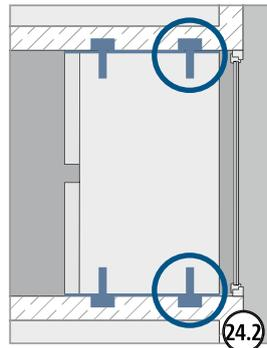
Einsatz von druckfesten **Ausgleichsplatten** (z. B. Stahl, Mindestgröße 180 × 120 mm) oben auf dem Wandelement Tronsole® Typ P Part W, zur Sicherung gegen Abheben des Podests.
