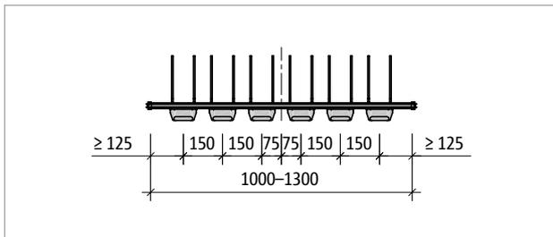
Abb. 125: Schöck Tronsole® Typ T-V6...-L1000 bis L1300: Produktgrundriss
