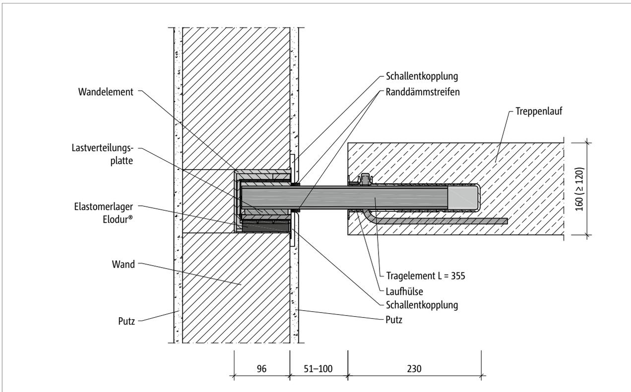
Abb. 84: Schöck Tronsole® Typ Q-FV-XL oder Q-A2-XL: Einbauschritt
