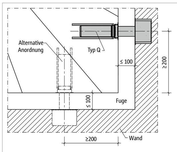
Abb. 90: Schöck Tronsole® Typ Q: Elementanordnung, Detail B
