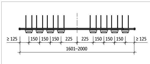
Abb. 130: Schöck Tronsole® Typ T-V8-...-L1601 bis L2000: Produktgrundriss
