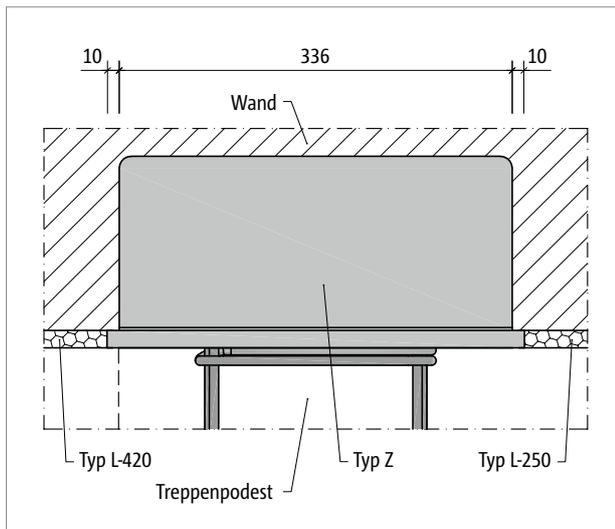
Abb. 64: Schöck Tronsole® Typ Z: Elementanordnung, Detail A
