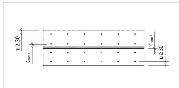
Abb. 167: Schöck Tronsole® Typ F: Vertikalschnitt quer zur Treppe im Bereich des Konsolauflagers; Darstellung der Betondeckung  $c_{nom,L}$ ,  $c_{nom,P}$  und des Mindestachsabstandes  $u$  der Bewehrung
