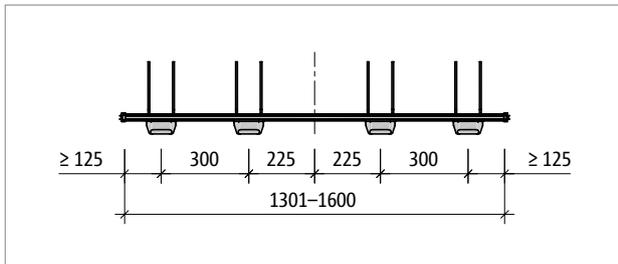
Abb. 123: Schöck Tronsole® Typ T-V4...-L1301 bis L1600: Produktgrundriss
