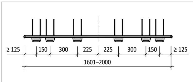
Abb. 127: Schöck Tronsole® Typ T-V6...-L1601 bis L2000: Produktgrundriss
