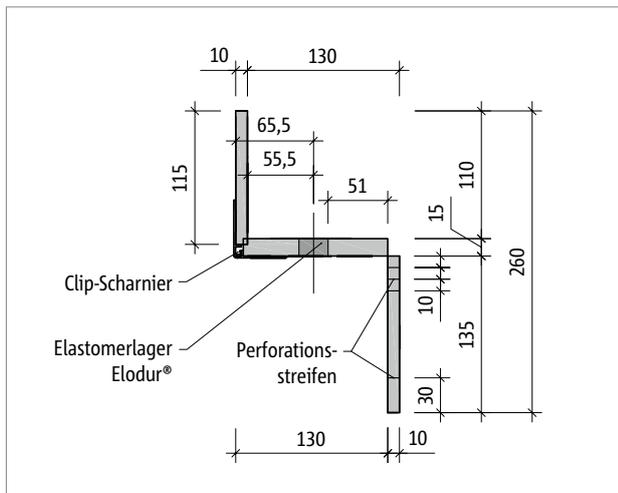
Abb. 155: Schöck Tronsole® Typ F-V1, F-V2, F-V3: Produktschnitt, Schnitt A-A, bei Anpassung an die minimale Konsoltiefe
