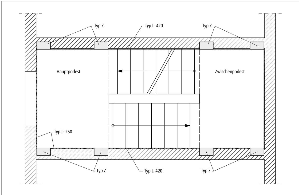
Abb. 191: Schöck Tronsole® Typ L-250 und Typ L-420: Schallschutzlösung für Treppenläufe und Podeste unter Einbeziehung der Tronsole® Typ Z
