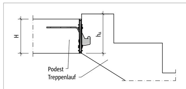
Abb. 132: Schöck Tronsole® Typ T: Anschlusshöhe  $h_A$
