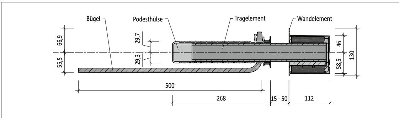
Abb. 31: Schöck Tronsole® Typ P: Produktschnitt A-A
