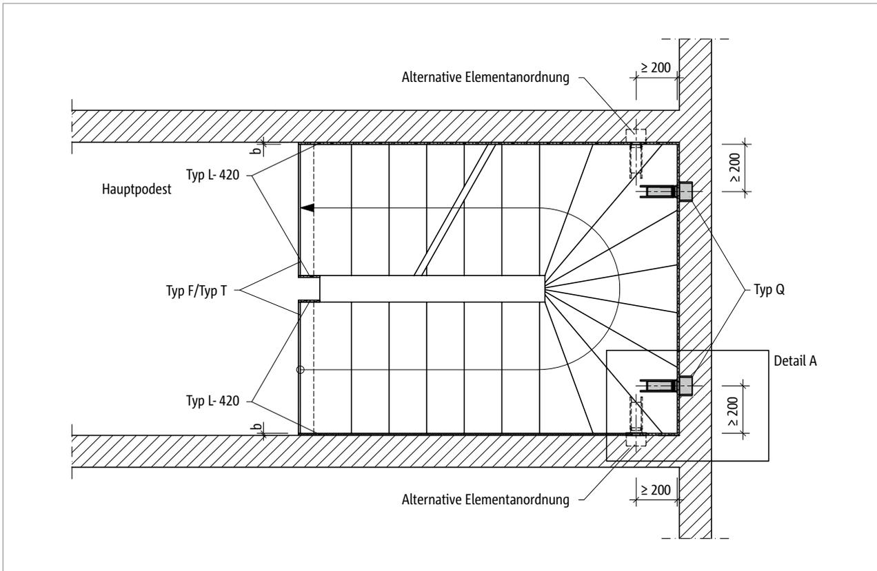
Abb. 87: Schöck Tronsole® Typ Q: Elementanordnung im Grundriss mit Verwendung der Tronsole® Typ L
