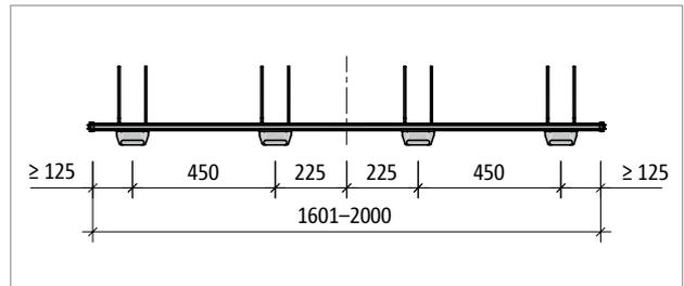
Abb. 124: Schöck Tronsole® Typ T-V4...-L1601 bis L2000: Produktgrundriss
