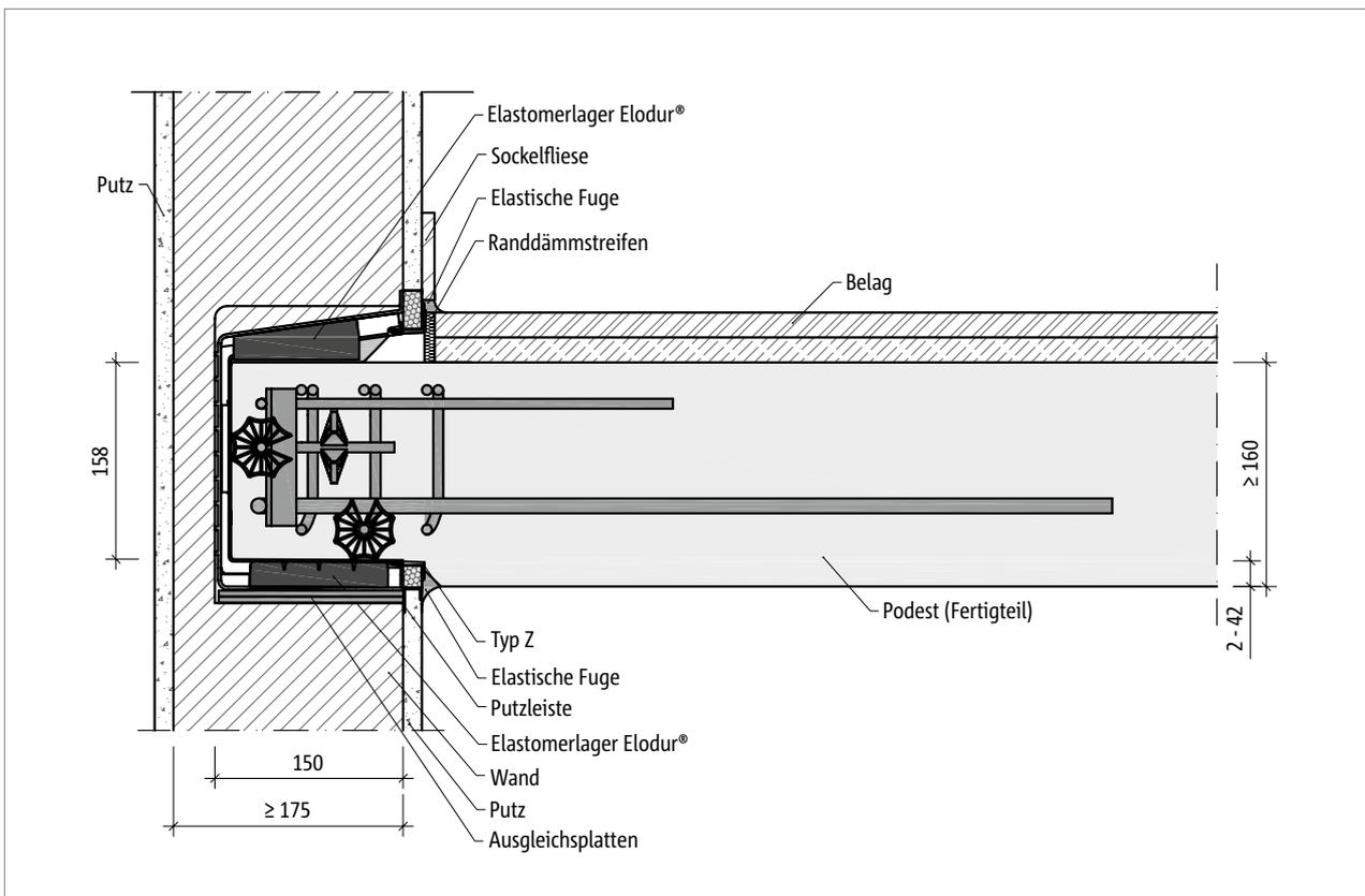
Abb. 61: Schöck Tronsole® Typ Z-V+V-T: Einbauschnitt Fertigteilpodest
