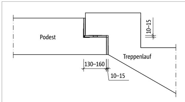
Abb. 145: Schöck Tronsole® Typ F: Ausführungsvariante überhöhter Treppenanschluss
