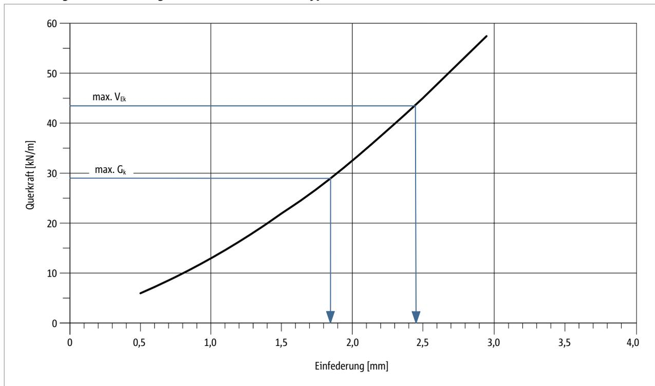
Abb. 186: Schöck Tronsole® Typ B-V2: Verformung des Elastomerlagers Elodur®
