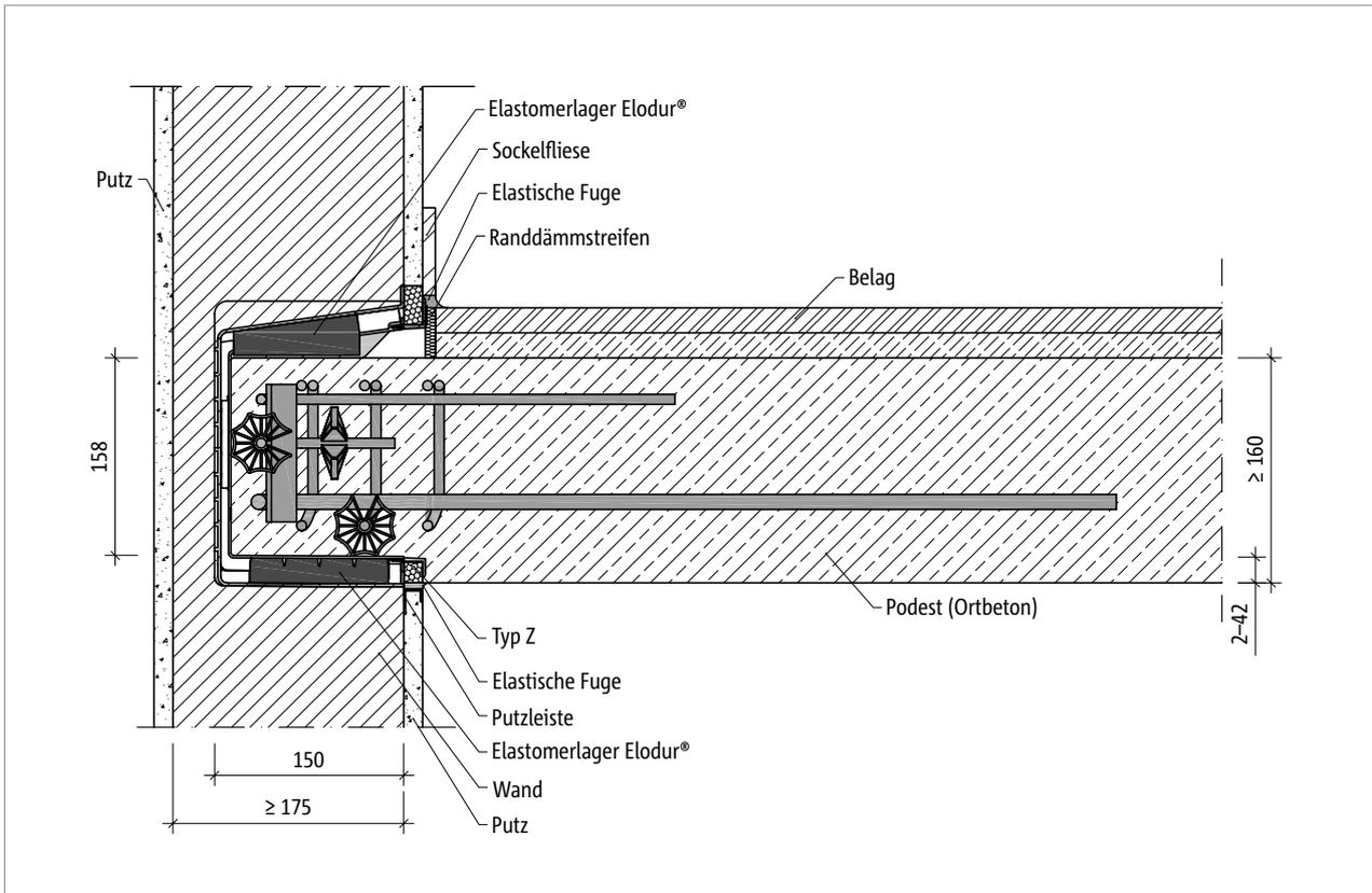
Abb. 60: Schöck Tronsole® Typ Z-V+V-T: Einbauschnitt Ortbetonpodest
