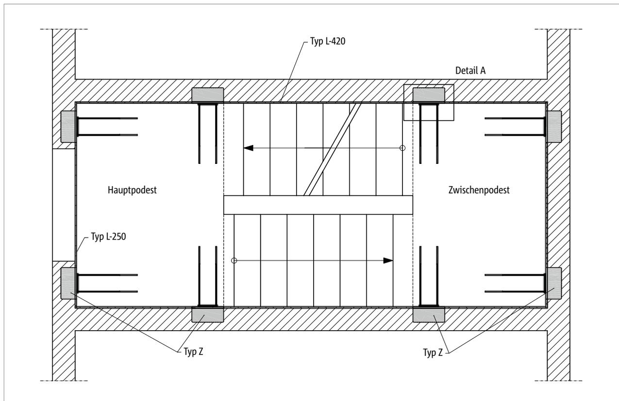
Abb. 63: Schöck Tronsole® Typ Z: Alternative Elementanordnung im Grundriss
