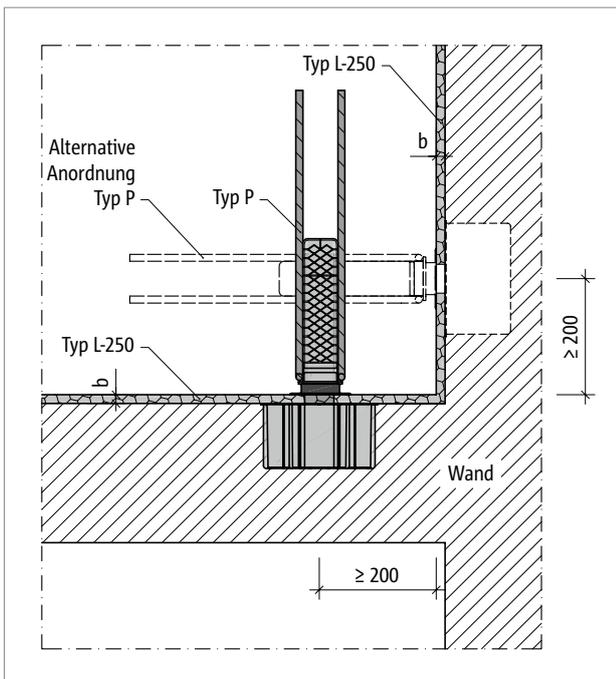
Abb. 25: Schöck Tronsole® Typ P: Elementanordnung, Detail A, Fugenbreite  $b = 15 \text{ mm}$  bei Ortbeton, bei Fertigteiltreppenläufen ist die Notwendigkeit einer zusätzlichen Einbautoleranz durch den Planer zu prüfen
