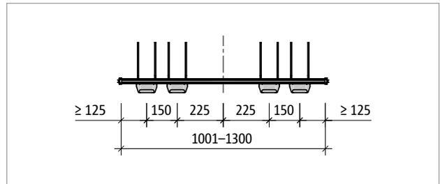
Abb. 122: Schöck Tronsole® Typ T-V4...-L1001 bis L1300: Produktgrundriss
