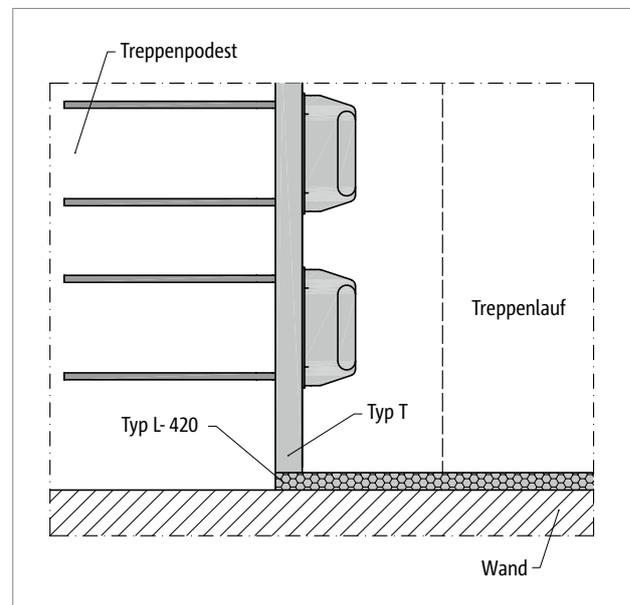
Abb. 113: Schöck Tronsole® Typ T: Elementanordnung Detail B
