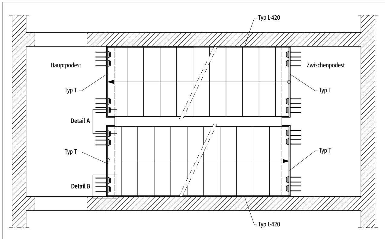
Abb. 111: Schöck Tronsole® Typ T: Elementanordnung im Grundriss
