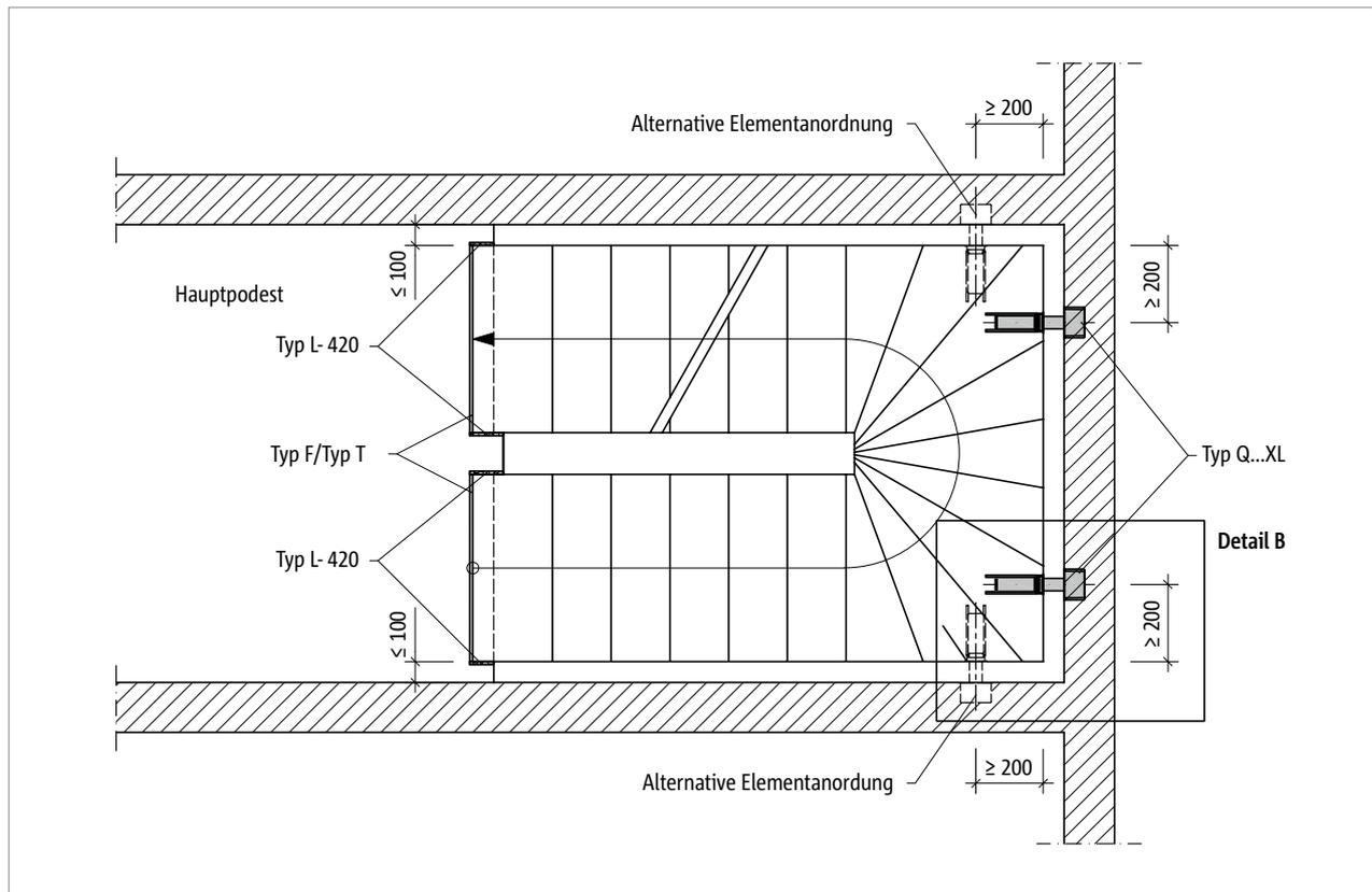
Abb. 89: Schöck Tronsole® Typ Q...XL: Elementanordnung im Grundriss bei einer Fugenbreite von maximal 100 mm
