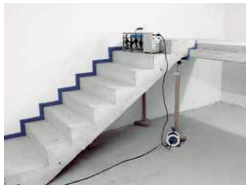
Realitätsnaher Prüfaufbau nach DIN 7396
