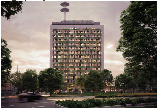
Ein Screen mit geschwungenen Balkonen prägt die Optik von Ode Lofts Konstanz. Der sichere Anschluss der fassadenbreiten Balkonanlagen erfolgte mit Schöck Isokorb T Typ K. Visualisierung: Sauerbruch Hutton / BPD Immobilienentwicklung
