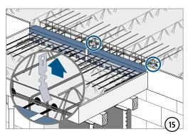
Vor Betonage alle roten Warnhinweise entfernen!
