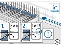
Zulagestäbe mit  $\varnothing \ge 8$  mm an Kreuzungspunkte anbinden. Zulagestab mit  $\varnothing \ge 12$  mm direkt an Zugstab mit Ankerkopf anbinden!
