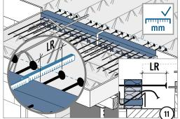
Einbindelänge LR gemäß Typenetikett prüfen!
