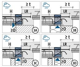
**3A:** Außenkante Isokorb® vor Außenkante Wand setzen. **3B–3D:** Unterkante Isokorb® direkt an oder über Unterkante Unterzug setzen.
