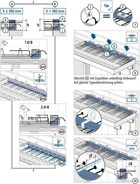
Einbindelänge LR gemäß Typenetikett prüfen!
