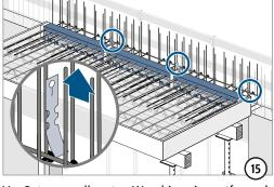
Vor Betonage alle roten Warnhinweise entfernen!
