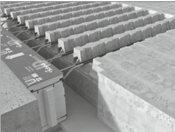
Abb. 9: Schöck Isokorb® Ausführungsvariante ID: Der Fertigteilbalkon hängt am Kran; die Stäbe des Schöck Isokorb® werden in die vorbereiteten Deckenaussparungen bewegt
