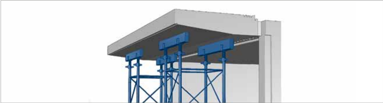
Abb. 183: Schöck IDock®: Abstützung des Vollfertigteilbalkons auf dem darunterliegenden Balkon
