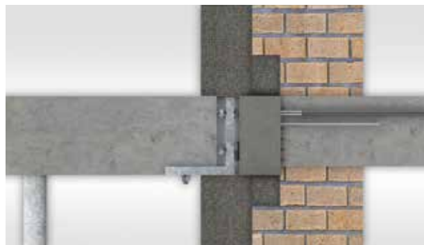
Gestützter Stahlbetonbalkon, nachträglich angeschlossen mit Schöck Isokorb® RT Typ SKP an bestehende Stahlbetondecke im Mauerwerk.
