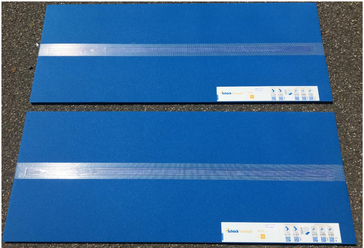
Abbildung 5: Geprüfte Schöck Tronsole® Typ B-V1-L1500 (oben) und Typ B-V2-L1500 (unten)
