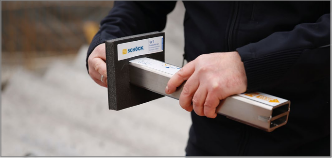
Abb. 72: Bei Brandschutzanforderung R 90 Brandschutzmanschette auf Tragelement aufstecken
